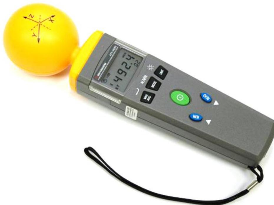
Рисунок 4 – Измеритель уровня электромагнитного фона АТТ-2592
